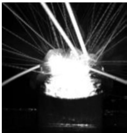
Figur 11: Vänster: Det finns många sprutsvetsar Höger: Den optimerade strålen minskar stänk avsevärt.
