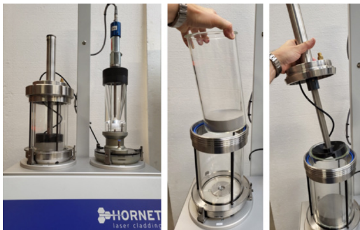
Figur 17: Hornets nya pulvermatare till vänster och en konventionell pulvermatare till höger (a). Endast två komponenter kommer i kontakt med pulvret (b) och (c).
