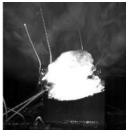
Figur 11: Vänster: Det finns många sprutsvetsar Höger: Den optimerade strålen minskar stänk avsevärt.
