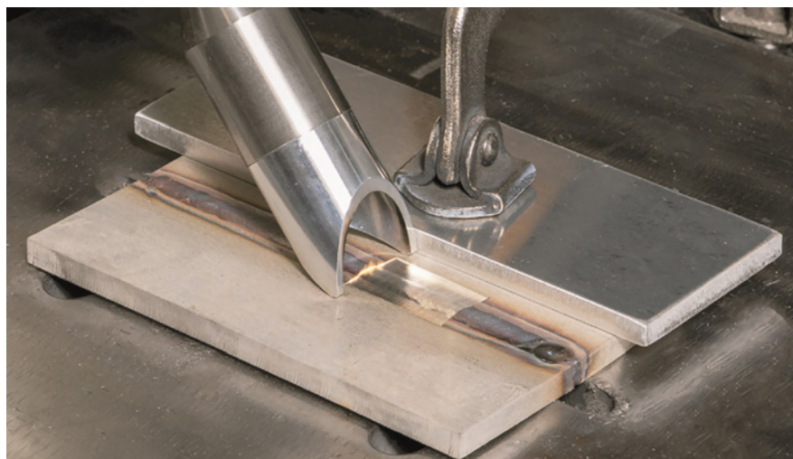
Figur 4: Med cleaningsmunstycket kan fogen eller materialet rengöras.
