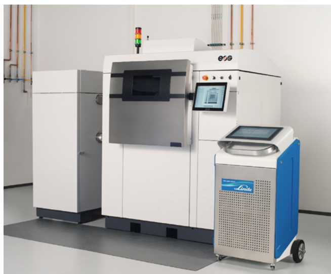
Figur 3: Utrustning för mätning och styrning av oxygenhalten i printkammaren.
