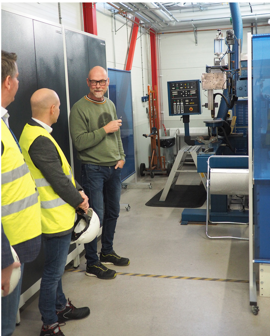
Peter Olsérius visade Höganäs ArcX Plasma Transferred Arc (PTA) för påsvetsning. Här den gamla manuella maskinen.
