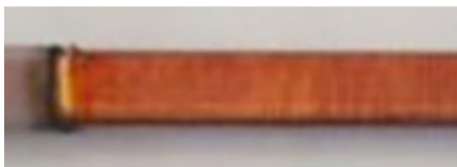
Figur 6: Färgförändring av koppar på grund av termisk påverkan
