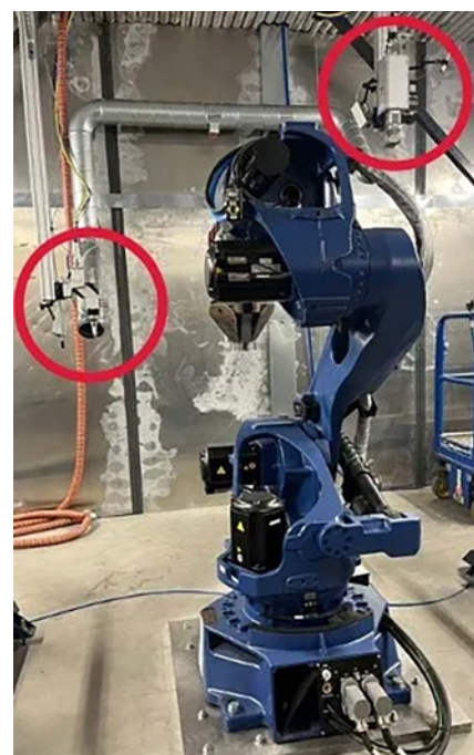
Roboten kan röra sig fritt mellan laserkällan uppe till höger i taket och cladding-applikationen till vänster.
