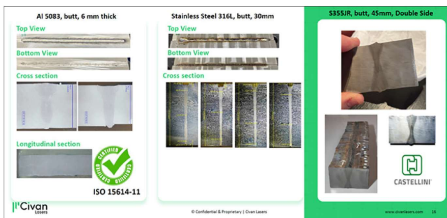
Figur 7: Civan laser används med dynamiskt fokus för att svetsa i tjocka gods av olika material.
