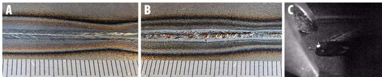
Figur 2: Svetsresultat i 2mm Strenx från SSAB, där a) är foto från ovasida, b) är motsvarande rotsida och c) bild från höghastighetsfilm.
